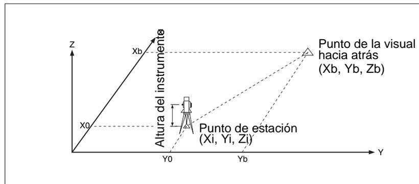
1. Para introducir las coordenadas para el punto de la visual hacia atrás (VA), presione **[F1]** o seleccione **Coord** en la pantalla **Vis. atrás**.
