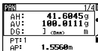
Si la cuenta media está configurada en 0, las mediciones se realizan de forma continua hasta presionar **[MSR1]**, **[MSR2]** o **[ESC]**. Cada vez que se realiza una medición, se actualizará la distancia.
