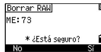
Si la configuración Grab MEM está especificada en Ambos, el sistema también eliminará los datos de coordenadas correspondientes cuando elimina un registro SS, SO o CP.
