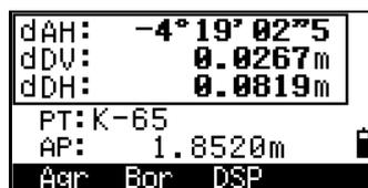
Para eliminar una medida (debido a valores sigma grandes, por ejemplo), resalte los datos de la medida o muestre la pantalla de detalles de la medida. Luego presione la tecla **BOR**. Las coordenadas EST se recalcularán automáticamente.
