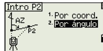
4. Si selecciona For ángulo, aparecerá la pantalla de introducción de acimut. Introduzca el valor de ángulo y presione [ENT].
