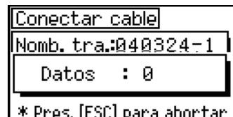
Si presiona `ESC` durante la carga de datos, la carga se cancelará y la pantalla volverá al menú Comunicación. Los registros que se han recibido antes de presionar `ESC` se almacenarán en el trabajo.
