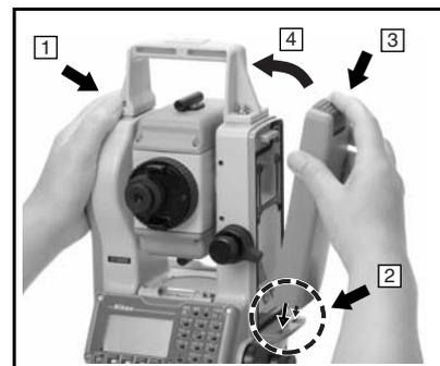
4. Empuje la carcasa de la batería contra el instrumento y libere el botón de montaje. Asegúrese de que el botón de montaje esté completamente liberado y que la batería esté colocada firmemente en el instrumento.
