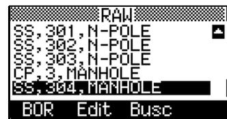
Mantenga presionado **[DAT]** durante un segundo en la PMB o una pantalla de observación para mostrar la pantalla Seleccionar formato. Use esta pantalla para cambiar el tipo de datos asignado a **[DAT]**. Presione **[1]** o seleccione **Dato [MENU]** para mostrar el menú Dato cada vez que presiona **[DAT]**.
