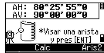
Si ha realizado una medición de distancia al centro del círculo, presione la tecla **Calc** para calcular el desplazamiento utilizando la observación del ángulo de la arista.
