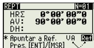
4. Para finalizar la medición de ángulos por repetición, presione [ESC].
