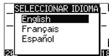
El paquete de idiomas #1 es el paquete por defecto instalado en fábrica. Los otros paquetes de idioma pueden instalarse con un proveedor de servicios de estaciones totales Nikon autorizado.
