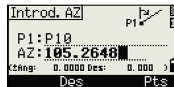
7. Para calcular las coordenadas del punto de intersección, presione **[ENT]** en el campo **AZ**.
