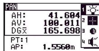
Para desplazarse por las configuraciones correspondientes a un control, presione el número junto al mismo. Por ejemplo, para encender o apagar la retroiluminación, presione **1**.
