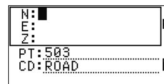
Para almacenar el punto como un registro MP y volver a la pantalla de introducción de puntos, presione **ENT** en el campo Z. El PT por defecto se incrementará al siguiente valor.
