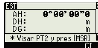
Una vez que ha completado la medición a P2, se calcularán las coordenadas de la estación.
