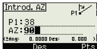
4. Introduzca el punto perpendicular a la línea o presione la tecla **MSR** para realizar una medición al punto.
