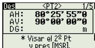
5. Si las dos paredes están en ángulo recto, presione la tecla **Calc** para calcular el punto de esquina con tres puntos.
