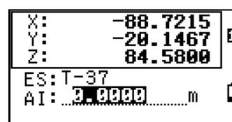
Cuando se cambia la AI, la coordenada Z se actualizará antes de que se grabe la estación. Deberá completar una configuración de estación antes de usar la función Cota remota.
