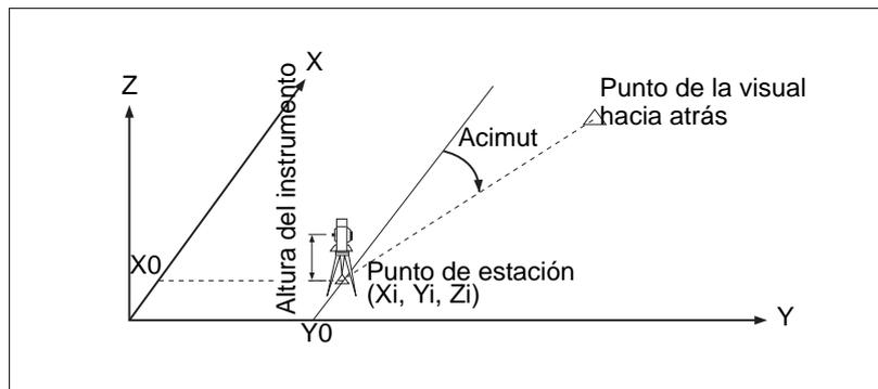
1. Para introducir el ángulo de acimut en el punto de la visual hacia atrás, presione **2** o seleccione **Ángulo** en la pantalla **Vis. atrás**.
