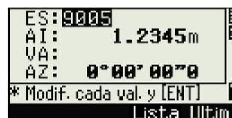
Si cambia los valores ES o AI, no se recalcularán las coordenadas de puntos de observación. Se almacenará un registro de comentarios para grabar el cambio. El siguiente ejemplo muestra un registro de comentarios para un valor AI cambiado:
