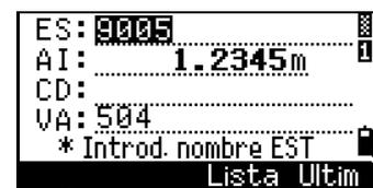
9. Vis. atrás (VA) estará por defecto en el primer punto (P1). Para cambiarla, resalte el campo VA y luego presione la tecla Cambio.
