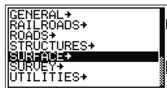
Una capa tiene una flecha al final de la etiqueta de código. Si resalta una capa en la lista y luego presiona  $\text{ENT}$ , se mostrarán los códigos y capas en dicha capa.
