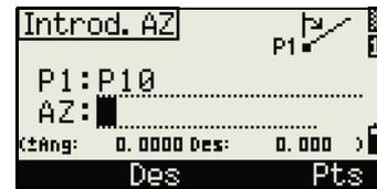
4. Para definir la línea por dos puntos, presione la tecla **Pts**. El campo **De** estará por defecto en el punto **P1**, pero podrá cambiar el punto seleccionado. En el campo **A**, introduzca o mida el segundo punto.
