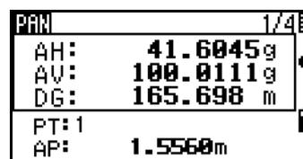
Mientras el instrumento está realizando una medición, la constante del prisma se mostrará con letras pequeñas.
