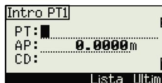
Vise el P1 y presione **[MSR1]** o **[MSR2]** para realizar una medición. Presione **[ENT]**.
