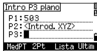
Si el plano está definido por dos puntos (seleccionando **2Pt**), el plano vertical es igual que el plano utilizado en la función **PLN-V**, pero los factores indicativos son **Dis** y **dZ**, no **a** y **b**. Véase más información en [Medición de valores de distancia y de desplazamiento en el plano vertical](#), página 76.
