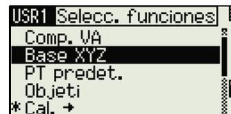
Para cambiar la función asignada a la tecla, presione  $\Delta$  o  $\nabla$  para resaltar la función. Luego presione  $\text{ENT}$ .
