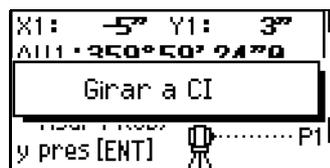
Una vez que ha realizado la medición, el mensaje en la línea de la parte inferior cambiará de ¡NO TOCAR! a Girar a CD.
