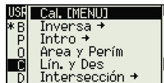
Para asignar una función específica del submenú, presione  $\Delta$  o  $\nabla$  para resaltar la función. Luego presione  $\text{ENT}$ .
