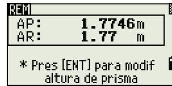
Se podrá utilizar una medida REM para actualizar la altura del objetivo. Realice una medición al prisma, vise la base del jalón para prismas y presione [ENT].
