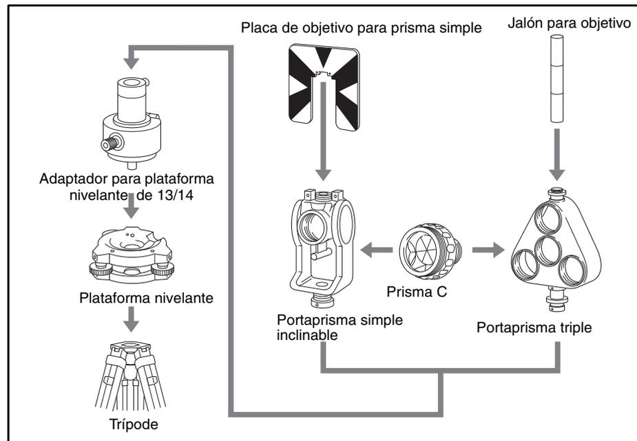
2. Ajuste la altura del adaptador para plataforma nivelante (véase la [página 16](#)).
