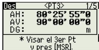
6. Si realiza una medición a un cuarto punto, el punto de esquina podrá calcularse como la intersección de dos paredes (P1-P2 y P3-P4). La elevación por defecto la proporcionará P4.
