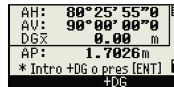
Si usa un prisma conectado a la superficie del círculo para la medición de distancia, presione la tecla **+DG** para eliminar el error de desplazamiento (desde el punto conectado hasta la superficie medida del prisma) antes de presionar **[ENT]**.
