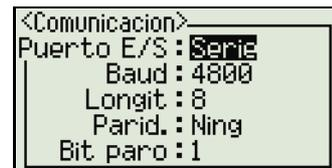
Utilice un cable RS-232C para conectar el instrumento a la computadora.
