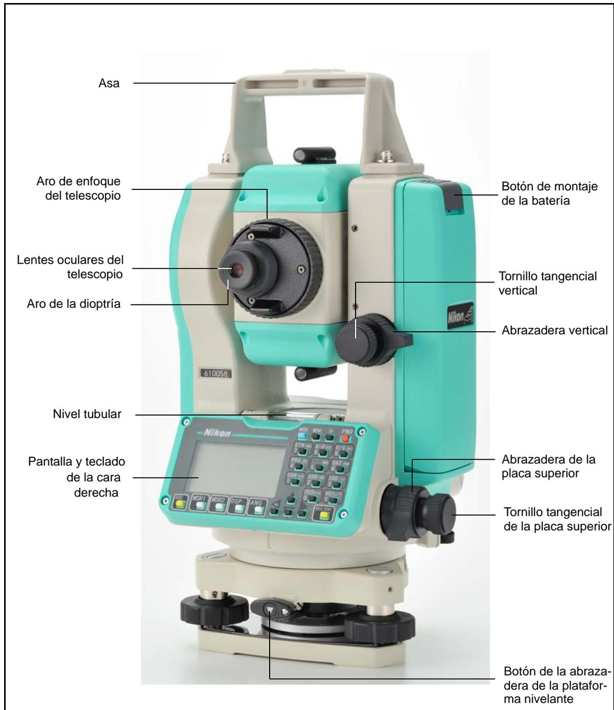
Figura 1.1 Estación total electrónica DTM-322 – Cara derecha
