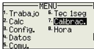
1. La DTM-322 dispone de compensación de nivelación en el eje solamente. Realice una medición CD a un objetivo en el horizonte. Presione **ENT**.
