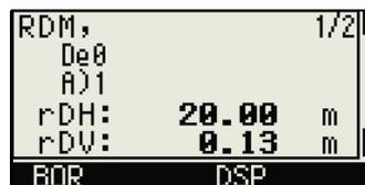
Presione **[DSP]** para cambiar entre la primera pantalla (que muestra De, A, rDH y rDV) y la segunda pantalla (que muestra rAZ, rDG, rV% y rGD).
