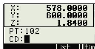
Una vez que ha grabado el punto, volverá a la pantalla de observación. Podrá continuar con la observación o presione **[ESC]** para introducir otro ángulo y distancia para el replanteo.
