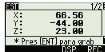
7. Para comprobar la medición, presione la tecla DSP. Si ha definido la línea introduciendo el acimut, se mostrarán la DH y la DV entre P1 y P2.
