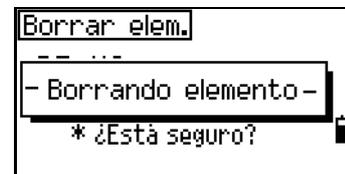
Para eliminar una capa completa, resalte el nombre de la capa en la lista y presione la tecla **BOR**. Se eliminarán todos los códigos y capas en la capa seleccionada.
