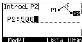
5. Para calcular las coordenadas del punto de intersección, presione **[ENT]**.
