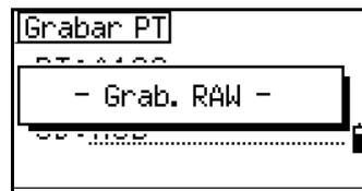
Si se ha movido AH o AV después de que se ha realizado una medición pero antes de presionar **[ENT]**, el ángulo grabado es el ángulo que se muestra cuando se presiona **[ENT]**.
