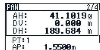
Por ejemplo, si actualmente se muestra la pantalla PAN2, presione **[DSP]** para pasar a la pantalla PAN3. El indicador de pantalla cambiará de 2/4 a 3/4.
