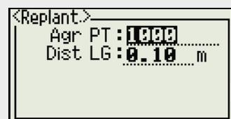
Tras grabar el punto, la pantalla volverá a la pantalla de observación. Cuando presiona [ESC], la pantalla volverá a la pantalla de introducción PT/CD/De. Si ha introducido el punto de replanteo utilizando un solo nombre de punto, el PT estará por defecto en el último PT + 1.
