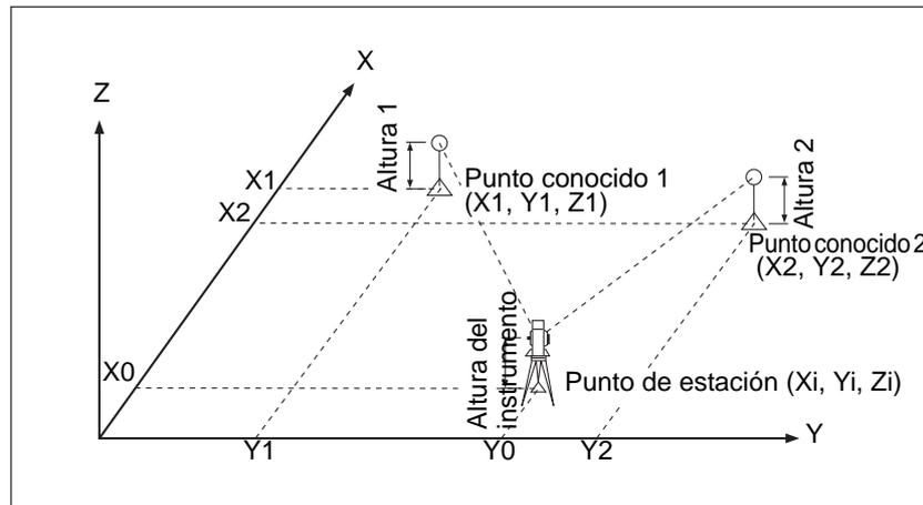
En una trisección, se puede utilizar un máximo de 10 puntos. Las medidas pueden ser de distancia y ángulo o de ángulo solamente. Los cálculos se inician automáticamente cuando se han realizado suficientes mediciones.
