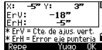
Si ErV, ErH, X ó Y está fuera de rango, se mostrará OVER. Presione una tecla para volver a la primera pantalla de observación.
