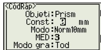
En las mediciones de código rápido, el Modo gra puede solamente configurarse en Confirm o Tod.
