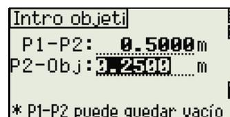
5. Si no introduce una distancia P1-P2, aparecerá la pantalla QA. Compare el valor introducido y la distancia medida para comprobar la precisión de la observación.
