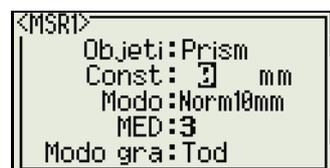
**Nota** – La constante del prisma de un prisma Nikon es siempre 0, independientemente de si está conectado a un portaprisma simple o triple.
