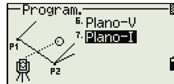
2. Introduzca tres puntos para definir el plano inclinado. Para introducir el punto por una medición directa, presione la tecla MSR.
