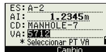
10. Para finalizar la configuración y grabar la estación, presione **[ENT]** en el campo VA.
