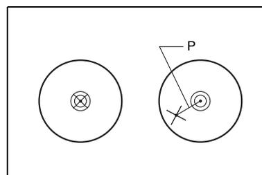
4. Si la imagen no está en la misma posición, ajuste la plomada óptica:
