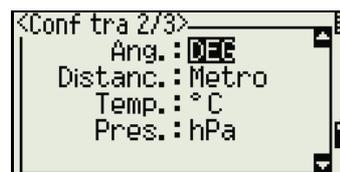
Si selecciona US-Ft o I-Ft, aparecerá una pantalla de configuraciones adicionales. Use esta pantalla para especificar si los valores se visualizarán en Decimal-Pi o Pi-Pulg.
