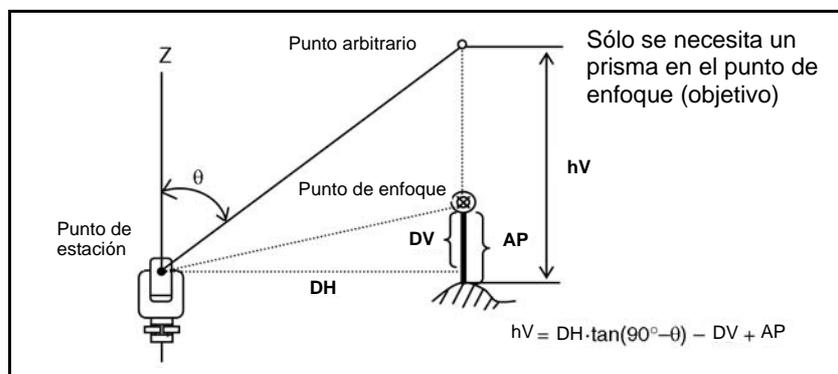
1. Para entrar en la función Medición de elevación remota, presione **[5]** o seleccione **REM** en el menú Program.
