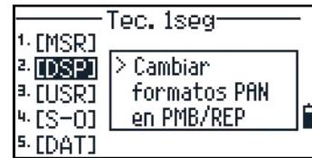
Para mover el cursor, utilice **[←]**, **[→]**, **[^]** o **[v]**. Para cambiar el elemento de visualización, presione la tecla **[↔]** o la tecla **[↔]**.
