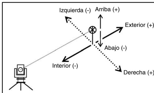
Podrá introducir una combinación de desplazamientos medidos con cinta métrica para especificar el punto.
