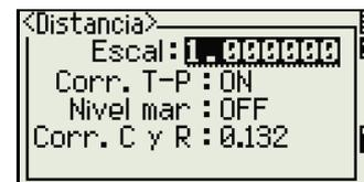
Las configuraciones de trabajo Escal, Corr. T-P, Nivel mar y Corr. C y R no pueden cambiarse una vez que se ha creado el trabajo.
