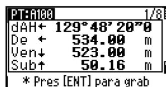
Para cambiar entre pantallas, presione [DSP]. Esta función trabaja como en el replanteo de ángulo-distancia, excepto que no se mostrará el contador de pantallas (por ejemplo, Rep1/8). Véase más información en [Utilización de \[DSP\] para cambiar entre pantallas, página 63](#).
