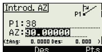
En el campo **Ang**, introduzca un valor positivo para rotar la línea en el sentido de las agujas del reloj. Introduzca un valor negativo para rotar la línea en el sentido contrario a las agujas del reloj.
