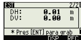
Si ha definido la línea introduciendo las coordenadas P2, se mostrará la diferencia de DH (dDH) y DV (dZ) entre los datos de medición y los datos de coordenadas introducidas.
