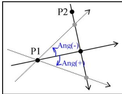
En el campo Des, introduzca un valor positivo para especificar un desplazamiento a la derecha. Introduzca un valor negativo para especificar un desplazamiento a la izquierda.
