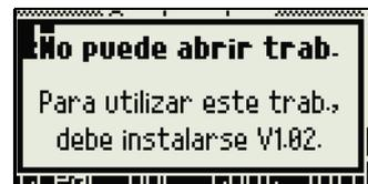
Los trabajos creados en la versión 1.02 o anterior no son compatibles con la versión 1.10 o posterior. Descargue todos los trabajos antes de actualizar el software que se está ejecutando en el instrumento.
