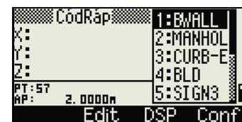
Si ha configurado el modo de registro en Confirm (véase [Configuraciones de medición, página 46](#)), la pantalla Grabar PT aparecerá tras cada medición.
