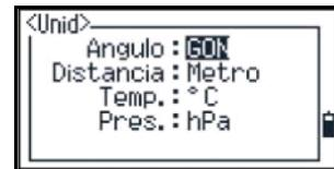
Si selecciona US-Ft o I-Ft, aparecerá una pantalla de configuraciones adicionales. Utilice esta pantalla para especificar si los valores se van a visualizar en Decimal-Pi a Pi-Pulg.
