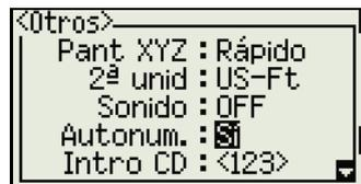
Si selecciona US-Ft o I-Ft, aparecerá una pantalla de configuraciones adicionales. Use esta pantalla para especificar los valores de visualización en Decimal-Pi o Pi-Pulg.
